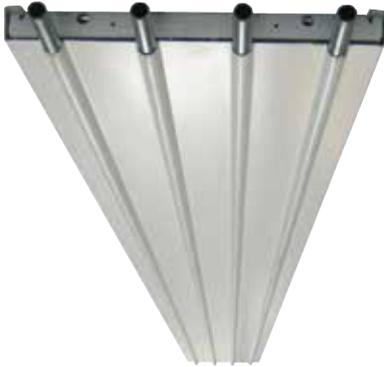
Die INFRA AQUA ECO ist eine wassergespeiste Deckenstrahlplatte die standardmäßig mit einer Mineralwollisolierung versehen ist. Die Isolierung verhindert eine Abstrahlung von Wärme nach oben. Diese Geräte bieten die Möglichkeit, ohne Luftbewegung zu heizen. Weiterhin wird die Wärme nur dort bereitgestellt, wo sie gebraucht wird. Durch die kurze Aufheizzeit und eine niedrige Raumtemperatur kann eine hohe Energieeinsparung realisiert werden.
