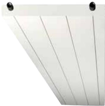
Die INFRA AQUA DESIGN ist eine wassergespeiste Aluminium-Deckenstrahlplatte, die standardmäßig mit einer Isolation aus Mineralwolle versehen ist. Diese Isolierung verhindert eine Abstrahlung der Wärme nach oben.
