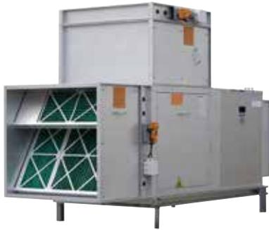
Neben dem Standard-Brennwert Gaswarmlufterzeuger hat MARK auch einen Brennwert Gaswarmlufterzeuger mit Radialventilator im Programm. Der GC+ ist insbesondere geeignet für den Anschluss an Kanalsysteme oder Systeme, in denen ein erhöhter Druck erforderlich ist. Dieses kondensierende Gerät besitzt einen Wirkungsgrad, der über 106% (unterer Wert) liegt. Die Wärme wird mittels eines modulierenden (5:1) Premix-Brenners erzeugt, was einen sehr niedrigen Gasverbrauch bewirkt.
