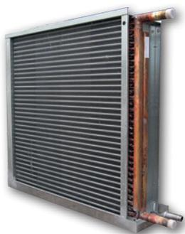
L'eau est refroidie dans l'unité de refroidissement. L'eau froide est pompée dans une batterie à eau froide située dans la centrale de traitement d'air. Cette eau permet de refroidir le flux d'air.
