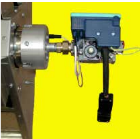
Afbeelding 3 – Aansluiting voor elektriciteit
